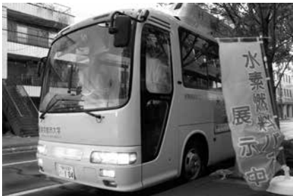
水素社会に向けた取り組みは（平成21年の水素普及啓発事業で走行した水素燃料エンジンバス）
