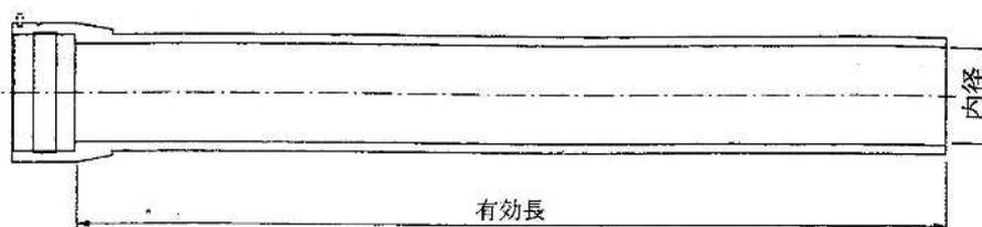
図7 - 18 下水道用ポリエチレン管
