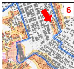
土砂災害特別警戒区域 および急傾斜地崩壊危険区域（対策済）を含む
