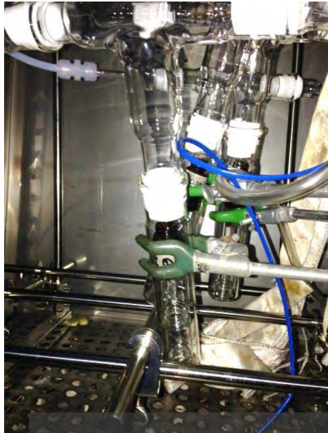
PCB蒸発管 設置状況
