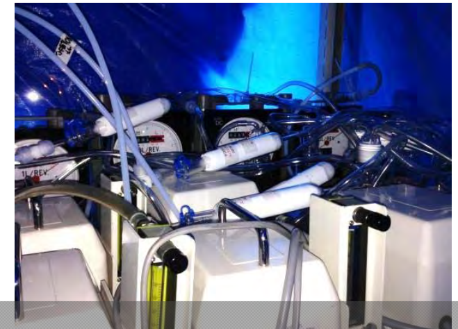
XAD樹脂充填カラム 設置状況
