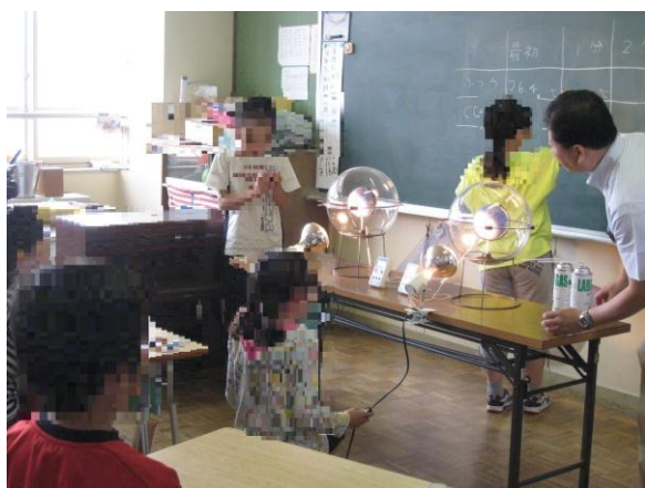
アクリルケースに入った地球儀を本物の地球に見立て、二酸化炭素が多く入った空気と通常のを温めて、温度差を調べる地球温暖化実験
