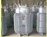
高圧トランス
