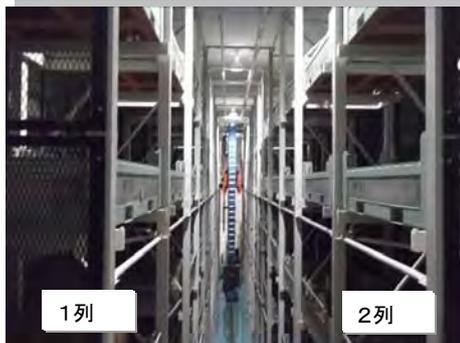
日本産業機械工業会における設計基準で設計(免震性確認:290galで実証)
