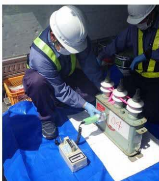
測定対象機器の 表面汚染密度の測定
