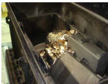
(鋼製ケース内処理後、穴から内部 構成部材がケース内に出ている)
