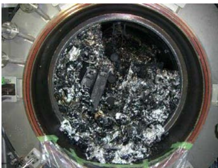
(ポリプロピレンを使用したコンデ ンサの炉内破裂した際の状況)
