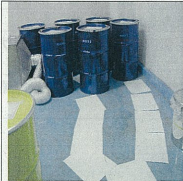
ドラム缶No. 8091から液体が漏れていた。 約2m長さ×200mm幅 (10:35)
