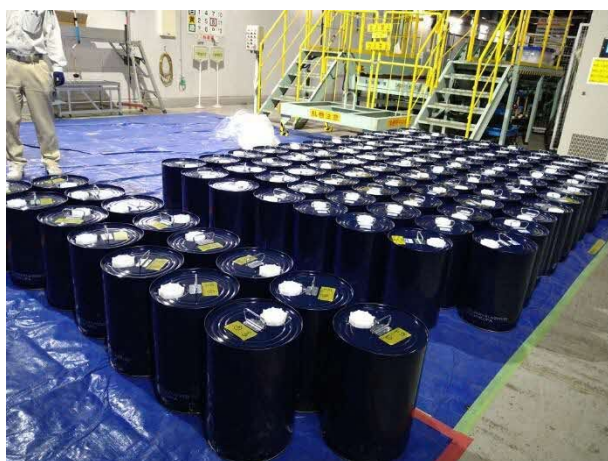
写真1：処理後物（廃アルカリ）の保管状況
