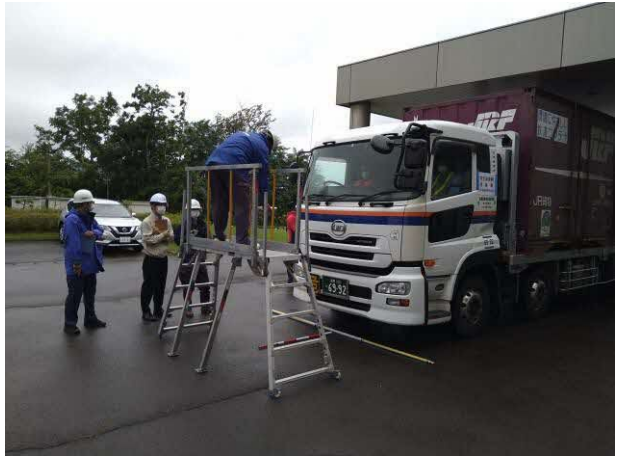
写真4：運搬車両の空間線量率測定状況
