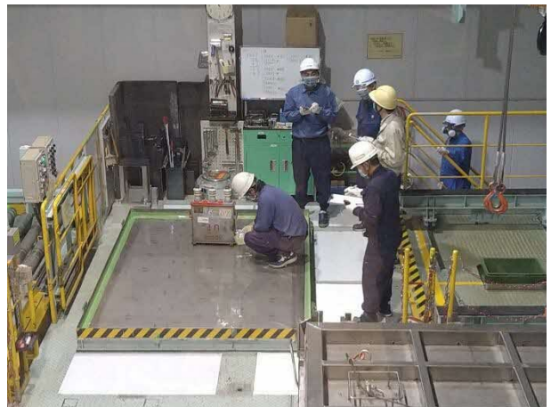
写真4：処理対象物の表面汚染密度の測定状況
