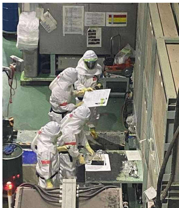
写真2：処理対象物（安定器）の表面汚染密度の測定状況②
