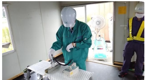
写真6：表面汚染密度測定状況（安定器）
