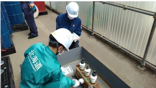
写真5：表面汚染密度測定状況（コンデンサ）
