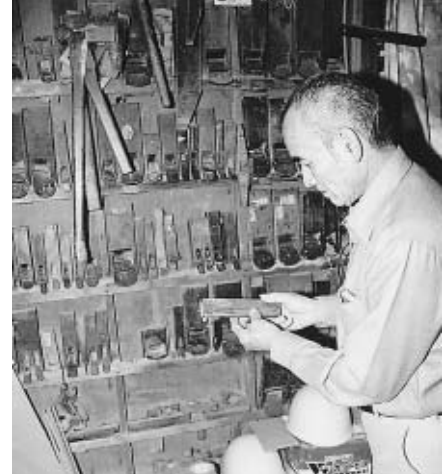
壁一面に並んだカンナは、大きさや形など様々で、品物や用途に応じて使い分けられる。道具は仕事の内容に合わせて自分で作ることもある。
