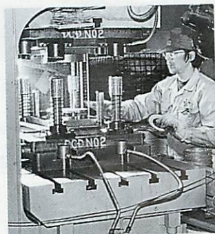
▲自動車用のクラッチ板を製造するプレス機
