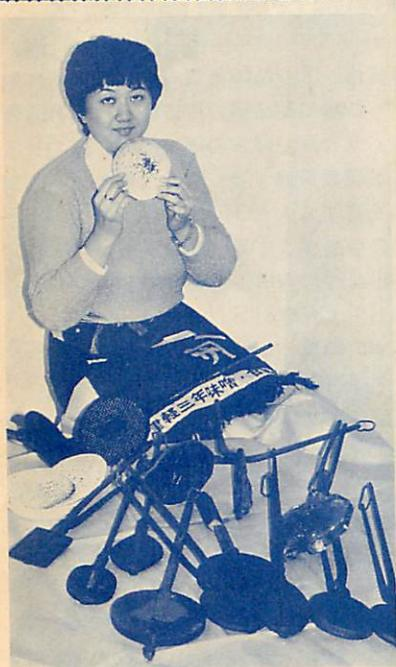
「せんべい」の形によつて、焼き型にもいろいろあります。表裏2枚合わせで、長い柄がついています。両手で柄を持ち、焼き型を開閉し、原料の小麦粉を水でこねたものをはさんで、炭火にのせ、1枚1枚焼きあげるので、いずれも長さが50cmあります。
