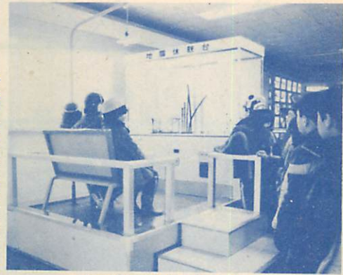
試運転中の「地震体験台」
