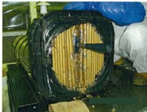
手解体作業の様子(特殊な形状のコンデンサ) (作業環境の悪化により、現在では同作業は実施していない。)
