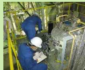
施設の排気出口にて、排気を測定している様子
