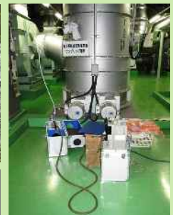
施設の排気出口にて、排気を測定している様子
