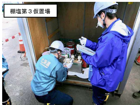
職員による表面汚染密度の測定
