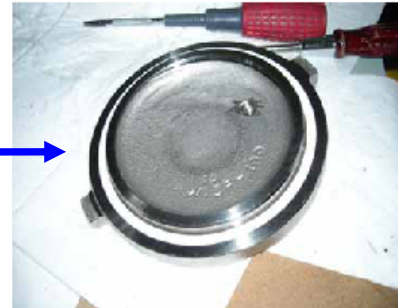
ST-A 蓋裏面⇒異常なし
