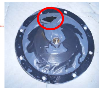
破損したダイヤフラム
