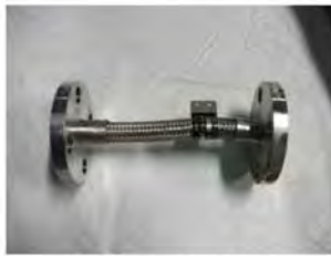
取外し後のフレキシブルホース
