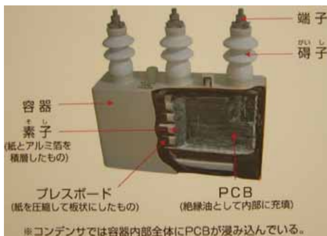
高圧コンデンサの内部構造
