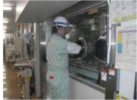
コンデンサの解体工程
