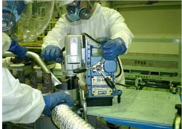
負圧管理を含む嚴重な閉鎖系内での作業、 保護具(呼吸用保護具、化学防護服等)を 着用 (JESCOの閉鎖系作業場内に入って撮影)
