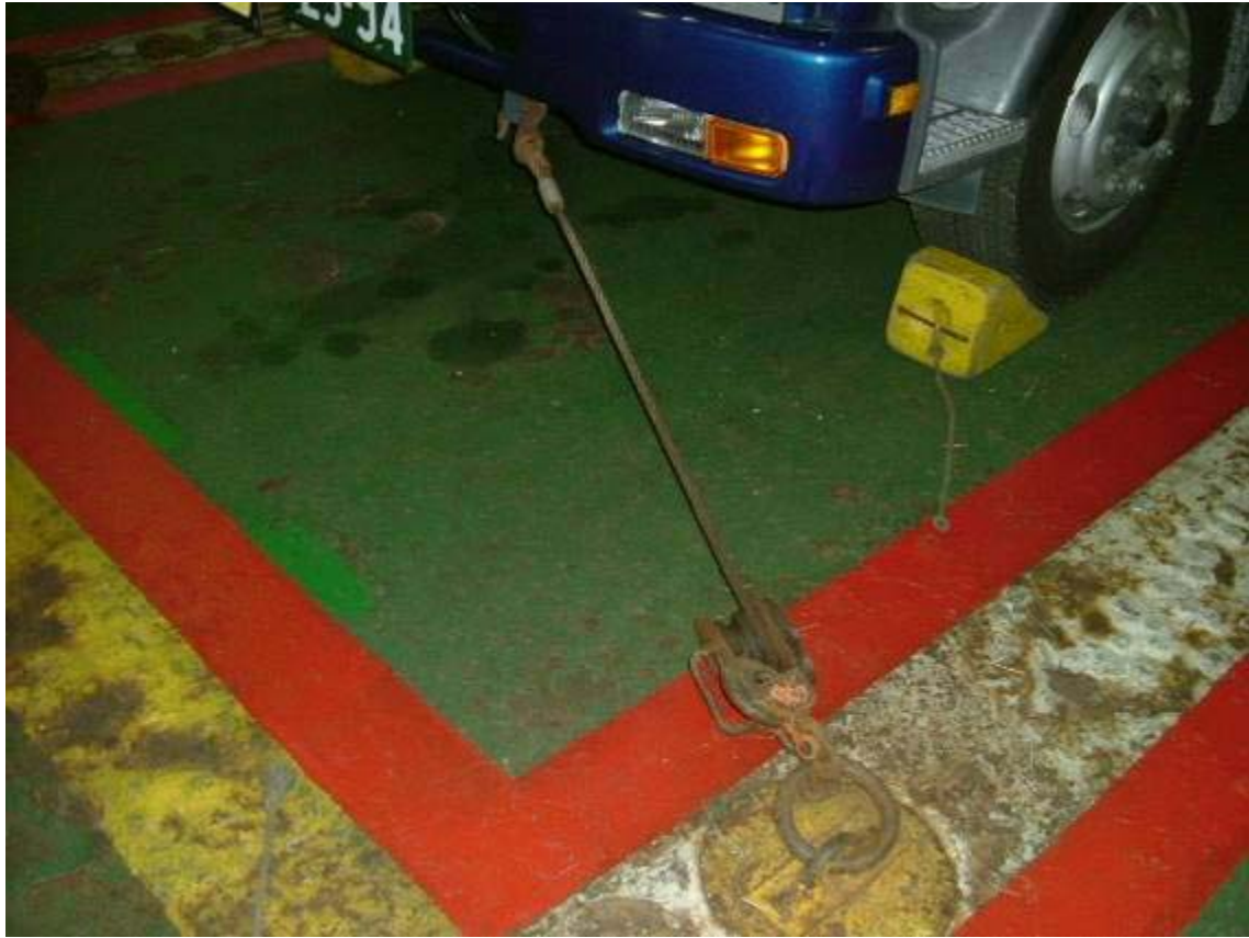
トラックとフェリーとのラッシング状況（前部左側）
