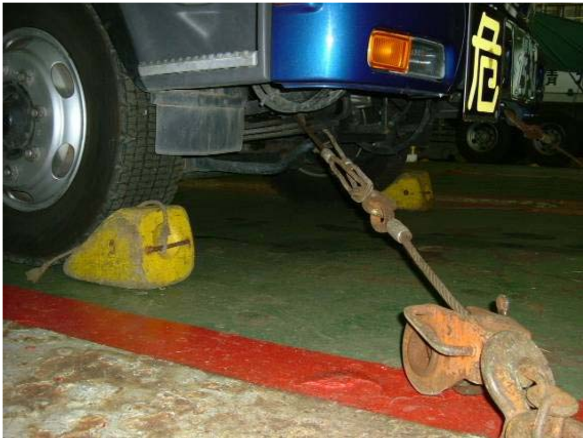
トラックとフェリーとのラッシング（前部右側） ウエッジ（車止め）
