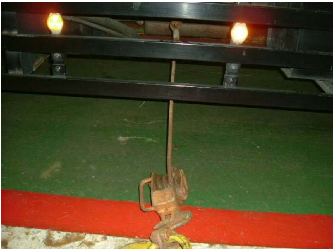
トラックとフェリーとのラッシング状況（左側面後側）
