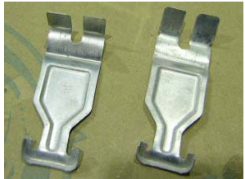
ボードとともに落下したクリップ (固定部が伸びている)
