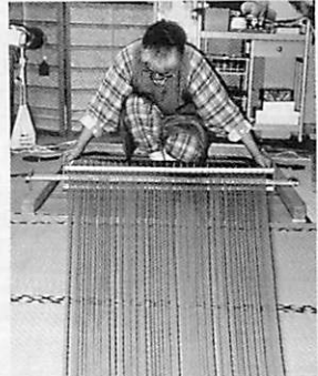
↑縦糸の準備 1千本以上にもなる染色した糸を、色の配置を考えながら、たるまないよう、ロールにしっかりと巻きつけていく。
