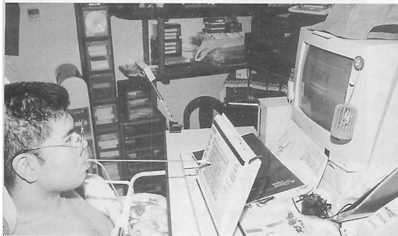
▲環境制御装置。ストローで送り込む空気の量を調節し、モニターに表示される0～49番までの番号を指定。家電品など50通りの操作方法がある。
