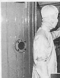
▲ミクロン単位で光学薄膜を張る真空蒸着機と製造された製品
