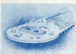
⑥築島上に頂板コンクリートを打ち込む
